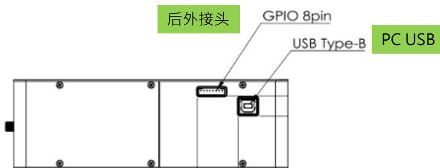
Fig. 6 : PD & PD-NIR系列 连接器机构图
