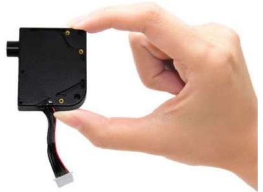
本产品介绍提供 UM Series 光谱模块相关的讯息及详细的操作方式。UM Series 光谱模块使用 Sony ILX563A 3000-element 或 Toshiba TCD1254 2500-element 高灵敏度线型传感器。使用者可使用 8 pin 接头外接电缆控制CCD传感器，达到系统整合目的。
